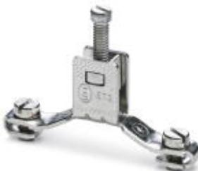
Клемма защитного провода, тип подключения: Винтовые зажимы, количество точек подсоединения: 2, полюсов: 1, сечение: 0,5 мм<sup>2</sup> - 16 мм<sup>2</sup>, AWG: 20 - 6, ширина: 8 мм, цвет: серебристый, тип монтажа: NS 35/7,5, NS 35/15
