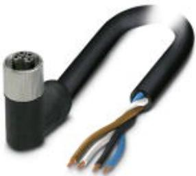
Силовой кабель, 4-полюсн., PUR без галогенов, темно-серый RAL 7021, Гнездо угловой M12, L-кодирование, к свободный конец, длина кабеля: 3 м, для постоянного тока до 16 А / 63 В
