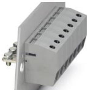
Проходная клемма, тип подключения: Винтовые зажимы, Подсоединение кабельного наконечника, полюсов: 1, ток нагрузки: 125 A, сечение: 6 mm<sup>2</sup> - 35 mm<sup>2</sup>, AWG 10 - 2, ширина: 15,1 мм, цвет: серый
