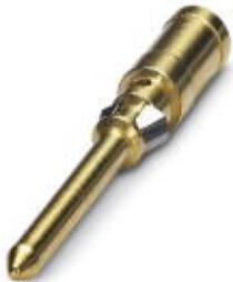
Механически обработанный обжимной контакт 1,6ег, штыревой, отдельный, сечение 0,14 - 0,37 мм<sup>2</sup>, позолоченный
