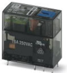
Вставное миниатюрное реле, с силовым контактом, 1 переключающий контакт, кнопка для тестирования, механический индикатор коммутационного положения, статусный светодиод, диод свободного хода, полярность A1+, A2-, входное напряжение 24 В DC
