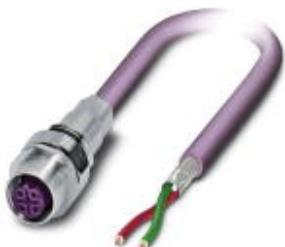
Встраиваемая розетка шинной системы, PROFIBUS, 2-полюсная, M12, экранированная, с механическим ключом В-типа, монтаж с передней части стенки / резьбовое крепление с M16, позиционируемая, с кабелем шины длиной 1 м, 2 x 0,25 мм<sup>2</sup>
