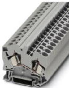
Проходные клеммы, номинальное напряжение: 800 В, номинальный ток: 41 А, тип подключения: Пружинный зажим, количество точек подсоединения: 2, сечение: 0,2 мм<sup>2</sup> - 10 мм<sup>2</sup>, AWG: 24 - 8, ширина: 8,2 мм, цвет: серый, тип монтажа: NS 35/7,5, NS 35/15
