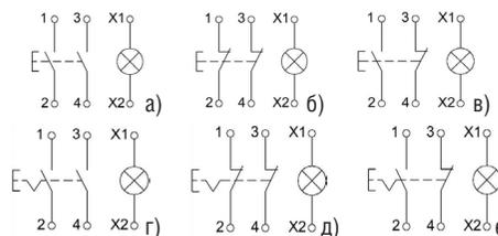
Рисунок В.3 – Принципиальные электрические схемы кнопки управления типа OptiDin KM63-C и типа OptiDin KM63-CF со встроенным световым индикатором зеленого цвета:
