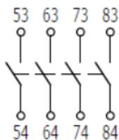
Рисунок Б.7 - Приставки контактные типов: ПКЛ-40, ПКЛ-М40
