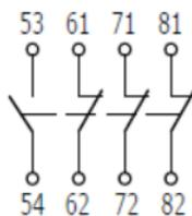
Рисунок Б.8 - Приставки контактные типов: ПКЛ-13, ПКЛ-М13
