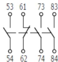
Рисунок Б.9 - Приставки контактные типов: ПКЛ-31, ПКЛ-М31
