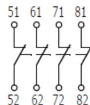
Рисунок Б.6 - Приставки контактные типов: ПКЛ-04, ПКЛ-М04
