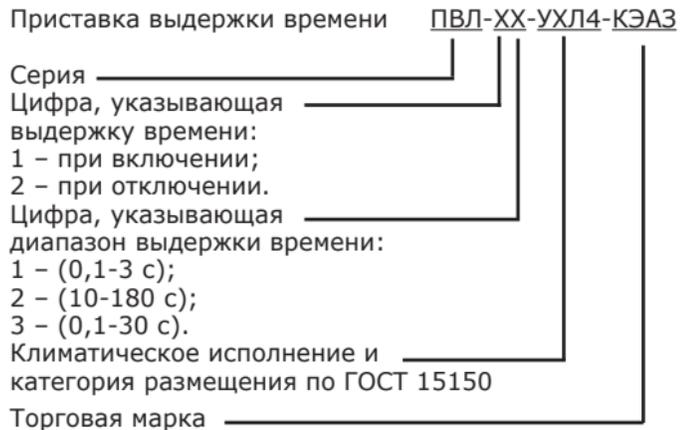
**Рисунок 2** – Структура условного обозначения приставок выдержки времени
