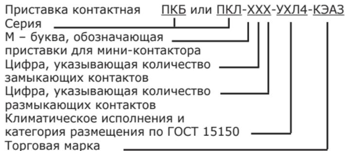
**Рисунок 1** – Структура условного обозначения приставок контактных
