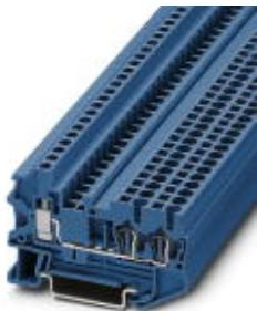
Проходные клеммы, тип подключения: Пружинный зажим, Винтовые зажимы, сечение: 0,08 мм<sup>2</sup> - 4 мм<sup>2</sup>, AWG: 28 - 14, ширина: 5,2 мм, цвет: синий, монтаж: NS 35/7,5, NS 35/15
