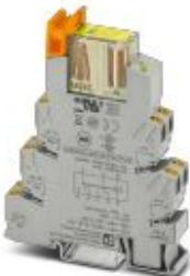
Релейная система PLC-INTERFACE, состоящая из базового модуля и вставного реле защиты с принудительно управляемыми контактами согласно DIN EN 50205, Зажимы Push-in, 2x переключающих контакта, с принудительным размыканием, Входное напряжение: 24 В DC
