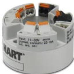
Измерительный преобразователь с питанием от выходного контура передает до двух сигналов датчиков RTD и TC, а также датчиков сопротивления и напряжения по протоколу связи HART или 4 ... 20 mA, с возможностью конфигурации. SIL 2/3, искробезопасность.
