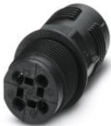
Проходная деталь, Тип подключения QUICKON, полюсов: 3+PE, 1 мм<sup>2</sup> ... 2,5 мм<sup>2</sup>, 690 В, 20 А, черный, без гайки QUICKON, монтажная резьба: M25, Зажимы Push-in, 2,5 мм<sup>2</sup>
