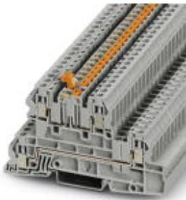
Монтажные многоярусные клеммы, со встроенным ножевым размыкателем, Винтовые зажимы, сечение: 0,2 мм<sup>2</sup> - 4 мм<sup>2</sup>, AWG: 24 - 12, ширина: 5,2 мм, цвет: серый, тип монтажа: NS 35/7,5, NS 35/15
