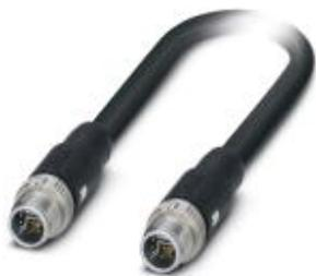
Комбинированный кабель, Ethernet Hybrid CAT5 (100 Мбит/с), 8-полюсн., PUR без галогенов, черный RAL 9005, экранирован., Штекеры прямое M12 SPEEDCON / IP67, механические ключи: Y, к Штекеры прямое M12 SPEEDCON / IP67, механические ключи: Y, длина кабеля: 5 м, Power with Ethernet (PWE)
