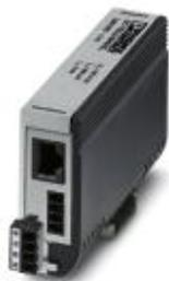
Промежуточный штекер с устройством защиты от импульсных перенапряжений, для двух телекоммуникационных интерфейсов SHDSL (Ports). Разъем: RJ45 (RJ12/RJ11) и вставная винтовая клемма (COMBICON). Возможность установки на несущую рейку.
