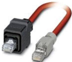
Кабель Sercos III, экранированный, четверка звездной скрутки, AWG 22, гибкий (7-проводочный), RAL 3020 (транспортный красный), на одном конце штекер RJ45 /IP67 с защелками, пластмассовый, на другом - штекер RJ45/IP20, длина: 5 м
