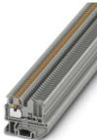
Проходная мини-клемма, номинальное напряжение: 500 В, номинальный ток: 17,5 А, тип подключения: Зажимы Push-in, количество точек подсоединения: 2, сечение: 0,14 мм<sup>2</sup> - 1,5 мм<sup>2</sup>, AWG: 26 - 14, ширина: 3,5 мм, цвет: серый, тип монтажа: NS 15
