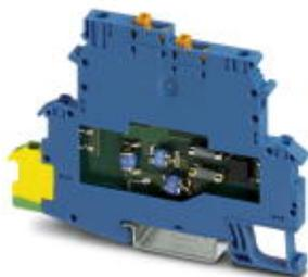
Электротехническая клемма с двухступенчатой защитой от импульсных перенапряжений для Ex i-сигнальной цепи без потенциала земли, ножевые разъединители в обеих сигнальных цепях, отдельное подключение PE, номинальное напряжение: 24 В DC
