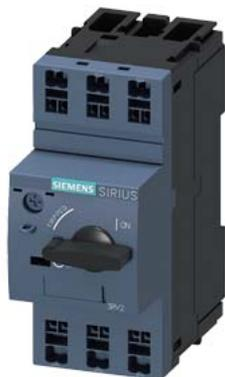
Автоматический выключатель, типоразмер S00 для защиты двигателя, класс срабатывания 10 Максимальный расцепитель тока с обратозависимой выдержкой времени 3,5–5 А N-расцепитель 65 А Подключение на пружинных клеммах Стандартная коммутационная способность
