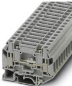
Клемма с размыкателем , тип подключения: Винтовые зажимы, сечение: 0,5 мм<sup>2</sup> - 10 мм<sup>2</sup> , AWG: 20 - 10, ширина: 8,2 мм, тип монтажа: NS 35/7,5, NS 35/15, NS 32, цвет: серый
