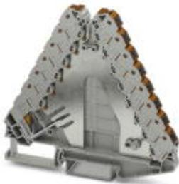
Распределитель потенциала, с возможностью подачи питания по линии до 6 мм<sup>2</sup>, номинальное напряжение: 250 В, номинальный ток: 17,5 А, сечение: 0,14 мм<sup>2</sup> - 2,5 мм<sup>2</sup>, AWG: 14 - 26, тип подключения: Зажимы Push-in, полюсов: 2, количество подключений: 29, ширина: 8,3 мм, длина: 100 мм, цвет: серый, цвет элементов подключения: коричневый, монтаж: NS 35/7,5, NS 35/15
