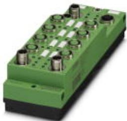
Автономное устройство для INTERBUS имеет 8 цифровых входов, нагрузка до 2 А. Подсоединение M12 производится с использованием системы быстрого подключения. Цепь питания 24 V DC защищена от короткого замыкания и перегрузки.
