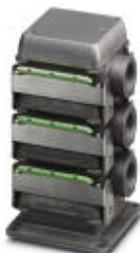
Duplison, комплект алюминиевых распределителей с базовым корпусом (с закрытой нижней частью), с тремя этажерочными корпусами с резьбовыми вводами M25 (без кабельных сальников), с тремя контактными вставками 6 x 4 мм<sup>2</sup> + PE, 400/690 В, 25 А, резьбовые зажимы и крышка корпуса, типоразмер В6, степень защиты IP67
