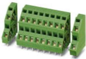
Клеммы для печатной платы, номинальный ток: 16 A, номинальное напряжение: 400 В, размер шага: 5 мм, полюсов: 4, тип подключения: Пружинный зажим, монтаж: Пайка волной припоя, направление подключения, проводник/печатная плата: 45 °, цвет: серый
