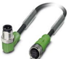
Кабель для датчика / исполнительного элемента, 3-полюсн., PUR без галогенов, темно-серый RAL 7021, Штекеры угловой M12, А-кодирование, к Гнездо прямое M12, А-кодирование, PIN 2+4 с перемычкой, длина кабеля: 0,3 м
