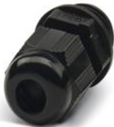
Кабельный ввод, материал резьбового соединения: PA, наружный диаметр кабеля 6 мм ... 11 мм, экранировка: нет, резьба соединительной части: M20 x 1,5, цвет: иссиня-чёрный RAL 9005, с элементом компенсации давления и плоским уплотнением, с плоским уплотнителем
