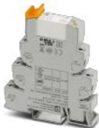
PLC-INTERFACE, состоит из основной клеммы PLC-BSC.../21 с винтовым зажимом и вставным миниатюрным реле с многосл. золотым контактом, для монтажной рейки NS 35/7,5, 2 переключающих контакта, входное напряжение 24 В DC
