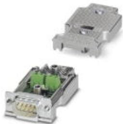
Разъем D-SUB (вилка), 9-полюсный, штыревая часть, осевое исполнение с двумя кабельными вводами, шинная система: PROFIBUS DP до 12 Мбит/с, нагрузочные резисторы подключаются ползунковым переключателем, расположение выводов: 3, 5, 6, 8; винтовые клеммы
