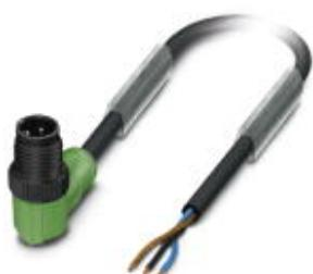
Кабель для датчика / исполнительного элемента, 3-полюсн., PUR без галогенов, темно-серый RAL 7021, Штекеры угловой M12, А-кодирование, к свободный конец, длина кабеля: 5 м, с пластмассовой накатанной гайкой
