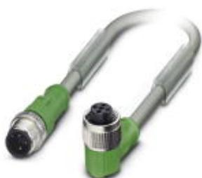
Кабель для датчика / исполнительного элемента, 3-полюсн., PUR без галогенов, стойкий к воздействию искр при сварке, повышенная гибкость, серый RAL 7001, Штекеры прямое M12, А-кодирование, к Гнездо угловой M12, А-кодирование, длина кабеля: 1,5 м, для использования на роботах и тяговых цепях
