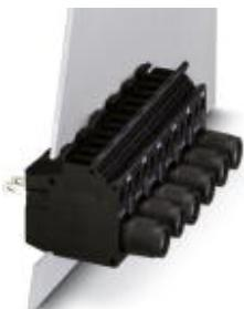
Проходная клемма, тип подключения: Винтовые зажимы, Контакты под пайку / разъем для подключения плоского штекера, полюсов: 1, ток нагрузки: 10 A, сечение: 0,2 mm<sup>2</sup> - 6 mm<sup>2</sup>, AWG 24 - 10, угол между направлениями подключения провода и установки разъема: 0 °, ширина: 12,2 мм, цвет: черный
