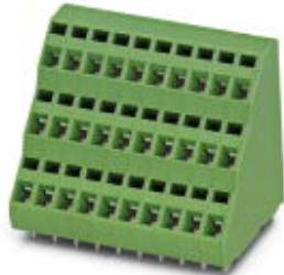
Клеммы для печатной платы, номинальный ток: 12 A, номинальное напряжение: 400 В, размер шага: 5,08 мм, полюсов: 16, тип подключения: Пружинный зажим, монтаж: Пайка волной припоя, направление подключения, проводник/печатная плата: 45 °, цвет: зеленый
