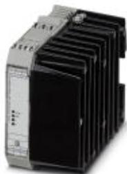
Трехфазный полупроводниковый реверсивный контактор со входом 230 В пер. тока, выходной ток 9 А, нулевой выключатель, опционально с устройством тепловой защиты
