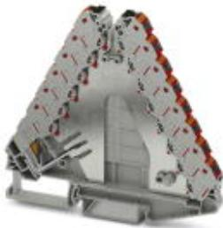
Распределитель потенциала, с возможностью подачи питания по линии до 6 мм<sup>2</sup>, номинальное напряжение: 250 В, номинальный ток: 17,5 А, сечение: 0,14 мм<sup>2</sup> - 2,5 мм<sup>2</sup>, AWG: 14 - 26, тип подключения: Зажимы Push-in, полюсов: 2, количество подключений: 29, ширина: 8,3 мм, длина: 100 мм, цвет: серый, цвет элементов подключения: красный, монтаж: NS 35/7,5, NS 35/15
