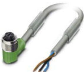
Кабель для датчика / исполнительного элемента, 3-полюсн., PUR без галогенов, стойкий к воздействию искр при сварке, повышенная гибкость, серый RAL 7001, свободный конец, к Гнездо угловой M12, А-кодирование, длина кабеля: 3 м, для использования на роботах и тяговых цепях
