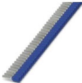
Кабельный наконечник, Размеры согласно DIN 46228-4, с пластиковыми втулками с цветовым кодом согласно NF C 63-023:1994-02, для работы с CRIMPFOX 4 in 1, длина наконечника: 8 мм, длина: 14 мм, цвет: синий, количество полос: 10, количество наконечников в полосе: 50
