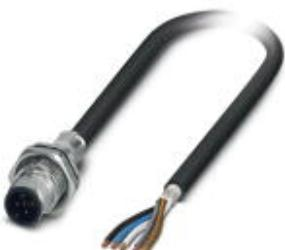
Встраиваемый штекер, экранированный, 5-контактный, M12, с механическим ключом A, монтаж по задней стенке/винтовой монтаж M16, с проводом 0,5 м, 5 x 0,34 мм<sup>2</sup>
