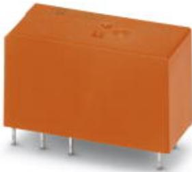
Вставное миниатюрное силовое реле RT III с силовыми контактами, 2 переключателя, входное напряжение: 110 В DC, в сочетании с соответствующим цоколем PLC имеет допуск в соответствии с ATEX/IECEx (зона 2) и зона Ex класс I, разд. 2.
