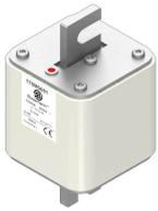
Предохранитель, высокая скорость, 1500 A, AC 800 V, size 3, 76 x 90 x 141 мм, aR, IEC, одинарный индикатор
