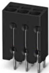
Клеммы для печатной платы, номинальный ток: 6 А, номинальное напряжение: 160 В, размер шага: 2,5 мм, полюсов: 6, тип подключения: Пружинные зажимы Push-in, монтаж: THR пайка, направление подключения, проводник/печатная плата: 90 °, цвет: черный
