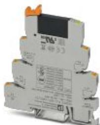
PLC-INTERFACE, состоит из базового клеммного модуля PLC-BPT.../21 с разъемом push-in и вставным миниатюрным полупров. реле, для монтажной рейки NS 35/7,5, 1 замыкающий контакт, вход: 24 В DC, выход: 3-48 В DC/100 мА
