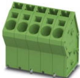
Клеммы для печатной платы, номинальный ток: 41 А, номинальное напряжение: 1000 В, размер шага: 7,5 мм, полюсов: 6, тип подключения: Пружинные зажимы Push-in, монтаж: Пайка волной припоя, направление подключения, проводник/печатная плата: 30 °, цвет: зеленый
