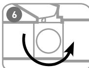
Поверните винт сброса давления в положение «Открыть».
