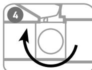
Поверните винт сброса давления в положение «Закрыть».
