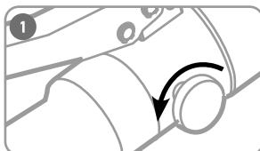
Поверните винт сброса давления в положение «Открыто».
