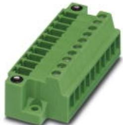
Блок для непосредственного монтажа, номинальный ток: 8 А, расчетное напряжение (III/2): 160 В, полюсов: 2, размер шага: 3,81 мм, тип подключения: Винтовой зажим с натяжной гильзой, цвет: зеленый, поверхность контакта: олово, монтаж: Непосредственный монтаж
