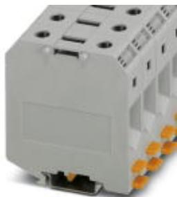
Клемма для высокого тока, с винтами с внутренним шестиугранником, номинальное напряжение: 1000 В, номинальный ток: 150 А, тип подключения: Винтовые зажимы, количество точек подсоединения: 2, полюсов: 1, сечение: 16 мм<sup>2</sup> - 70 мм<sup>2</sup>, AWG: 6 - 2/0, ширина: 20 мм, цвет: серый, тип монтажа: NS 35/7,5, NS 35/15, NS 32, NS 35/15-2,3
