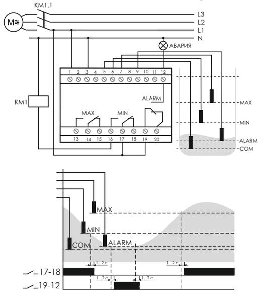
Для контроля аварийного уровня (ниже уровня MIN) внешняя перемычка между клемм 9 и 10 не устанавливается, зонда аварии ALARM подключается к клемме 9.
