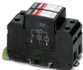
2-полюсный разрядник для защиты от перенапряжений, установка на DIN-рейку, для схемы 2+0, термодинамический контроль, визуальный индикатор неисправностей / контакт для дистанц. передачи сигнала.
