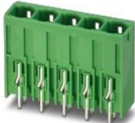
Корпусная часть для печатных плат, номинальный ток: 76 A, расчетное напряжение (III/2): 1000 В, полюсов: 3, размер шага: 10,16 мм, цвет: зеленый, поверхность контакта: Серебро, монтаж: Пайка волной припоя
