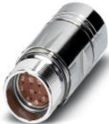
Переходные соединители, прямой, Винтовой зажим, M23, полюсов: 17, тип контактов: Розетка, Обжим, экранирован.: есть, диапазон диаметра кабеля: 5 мм ... 13,2 мм
